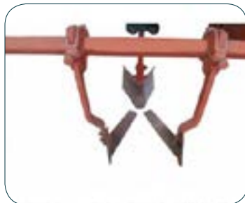
تصویر ۵- کولتیواتور با تیغه‌های چاقویی سرنیزه‌ای (تخت)
