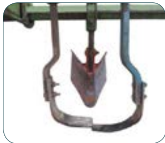
تصویر ۴- کولتیواتور با تیغه‌های چاقویی شمشیری (دارای انحناء)
