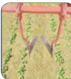
تصویر ۹- استفاده از کولتیواتور با تیغه‌های چاقویی سرنیزه‌ای جهت وجین علف‌های هرز در روش کشت مسطح
