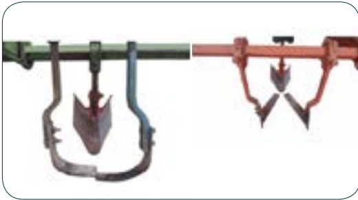
تصاویر و ۴ ۵ مربوط به دو نوع کولتیواتور با تیغه‌های چاقویی شمشیری و سرنیزه‌ای است. فاروئر یا شیار بازکن تعبیه شده در پشت تیغه‌های چاقویی، جویچه‌ها را دوباره شکل می‌دهد.
