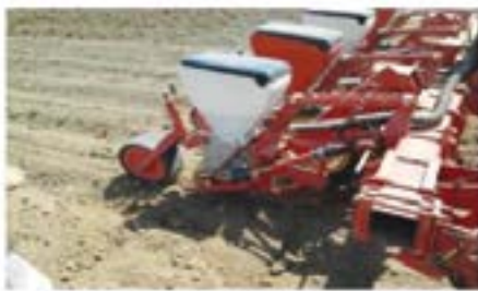
شکل ۳- استفاده از ردیف کار پنوماتیکی در کشت سویا
