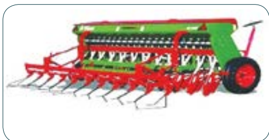
شکل ۲- تصویری از بذرکار غلات که برای کشت مکانیزه کلزا مورد استفاده قرار می‌گیرد
